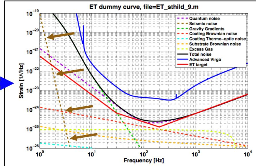
DRIVER: Seismic noise
